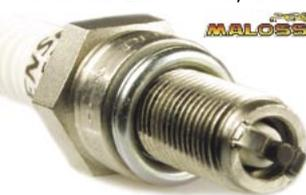
Eine relativ „heiße“ Kerze nimmt durch ihre Bauform viel Wärme auf, und leitet wenig Wärme an den Zylinderkopf ab. Damit erreicht sie schnell die Freibrenntemperatur in einem Triebwerk, das thermisch auf moderatem Niveau arbeitet - ein typischer Vorkriegsmotor etwa, oder ein braves Limousinentriebwerk mit geringer Literleistung.
